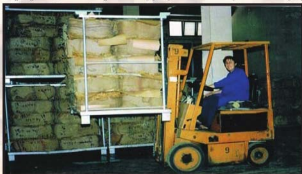
ۋىنەي (۲۲-۳) راقەي شەۋكى بۇ گواستەۋەي بالەي توتۇنەكان لەناۋ كۆگاي توتۇنى ترشېنراۋدا
