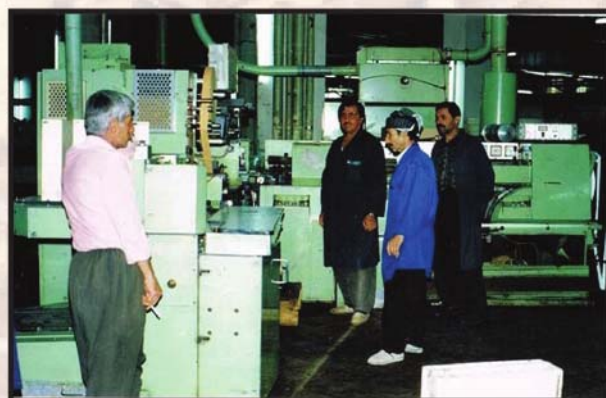
وێنەى (۲۵-۳) مەكىنەيەكى دروستکردنى جگەرە بە توانای ۴۰۰ جگەرە / خولەک بۆ ھەر مەكىنەيەك
