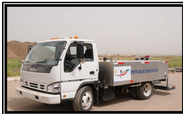
۱۲. Lavatory service vehicle – به کار دهیئریت بو پاککردنه وهی تواییتی فروکه کان.
