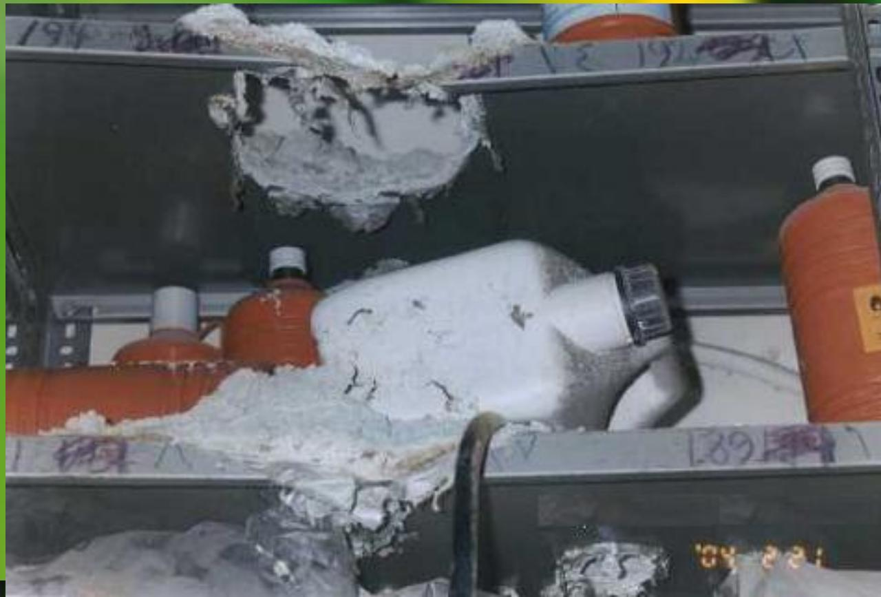
وكما نرى في الصورة تأكل أرفف التخزين الذي يؤدي لتلوث أرضية حجرة التخزين بمواد الكيميائية وعند تنظيفها تسبب في تلوث مياه الصرف الصحي.
