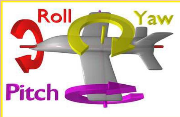
يكون الطيار الآلي مرتبط بجيروسكوب مؤشر الاتجاه ومؤشر الوجة ل يتم التحكم هيدروليكيًا بالرافع Elevators والدفة Rudder (الجنيح ليس مرتبطاً بذلك لأن الاعتماد عليه لإنتاج مايلزم من ثبات الميلان). وتجعل بذلك الطائرة تطير باستقامة ومستوى ثابت باتجاه البوصلة بدون الحاجة لانتباه الطيار مما يخفف العبء
