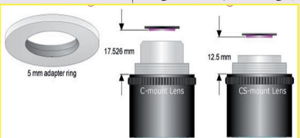
وێ لەم سەر دەمەدا شیاوێ ( CS-mount lens ) بە کاردەهێنرێت لە دروست کردنی کامیرا دا ئەمیش کە مترین بری تێچوونی هە یە و پێوهری هەستیارە کە ی بچوک دەکرێتەو بەلام لە کاتی بەکارهێنانی شیاوێ کە ی تەدا : ( C-MOUNT ) ئەو کاتە گۆرەری تاییەت بۆ ئەم کارە بە کار دەهێنن
