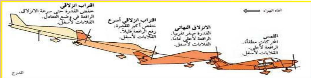
ذلك بالنسبة للمحركات النفاثة والمحركات المروحية، بتخفيض سرعة دوران المحرك لتخفيض قوة الدفع المتولدة، ومع انخفاض قوة الدفع، تنخفض أيضاً قوة الرفع لتبدأ الطائرة في الهبوط إلى أسفل. وفي نفس الوقت تزيد قوة السحب الهوائي فتتخفف سرعة
